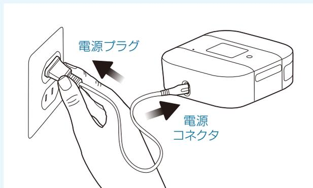
**注意** 電源コードは、過度の曲げや、ねじり、束ねなどによって断線し、発熱・発火におよぶ可能性があります。ご使用前には必ず破損がないことをご確認ください。
