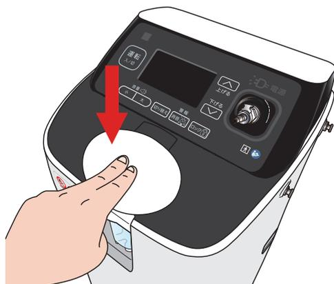
加湿器カバーの凹み部を押しながら加湿器カバーを閉めます。
