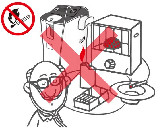
酸素は、それ自体は燃焼しませんが、**燃焼を助ける**ガス(支燃性ガス)です。酸素吸入中は次のような発火源の周囲2m以内に近づかないでください。
