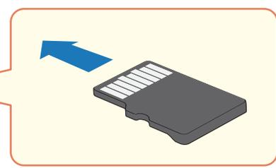
金属の端子を上側にして矢印の向きに挿入する。
