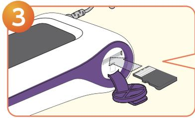
新しいSDカードをSDカードポートにカチッと音がするまで挿入する。
